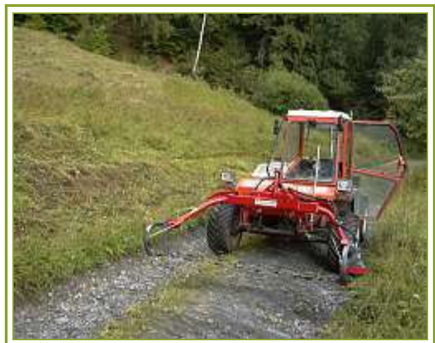
Traktor mit Front- Balkenmähwerk
